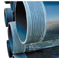
Assemblage par filetage/taraudage réalisé par piquages soudés aux extrémités des tubes. Prévu pour la pose des tubes à la verticale (captage bio-gaz).
