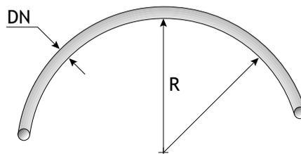
Lorsque les tubes sont posés à une température de 0° C, les rayons indiqués doivent être augmentés par un facteur de 2,5. Pour des températures comprises entre 0 et 20° C, le rayon autorisé peut être déterminé par interpolation linéaire.
